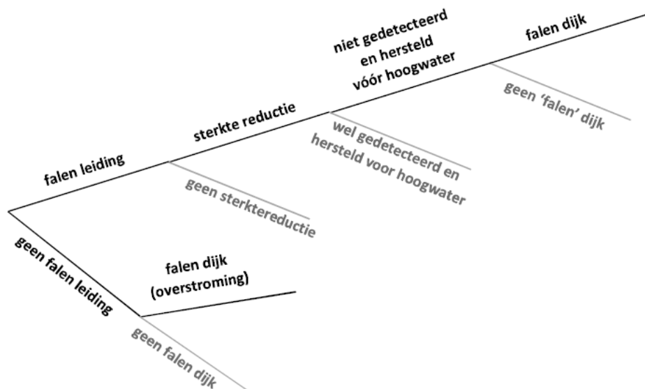
Figuur 1: Generieke gebeurtenissenboom voor het beoordelen van een waterkering met invloed van een falende leiding en beschouwing van de gelijktijdigheid van leiding falen en hoogwater (bron: Veiligheidsraamwerk)
